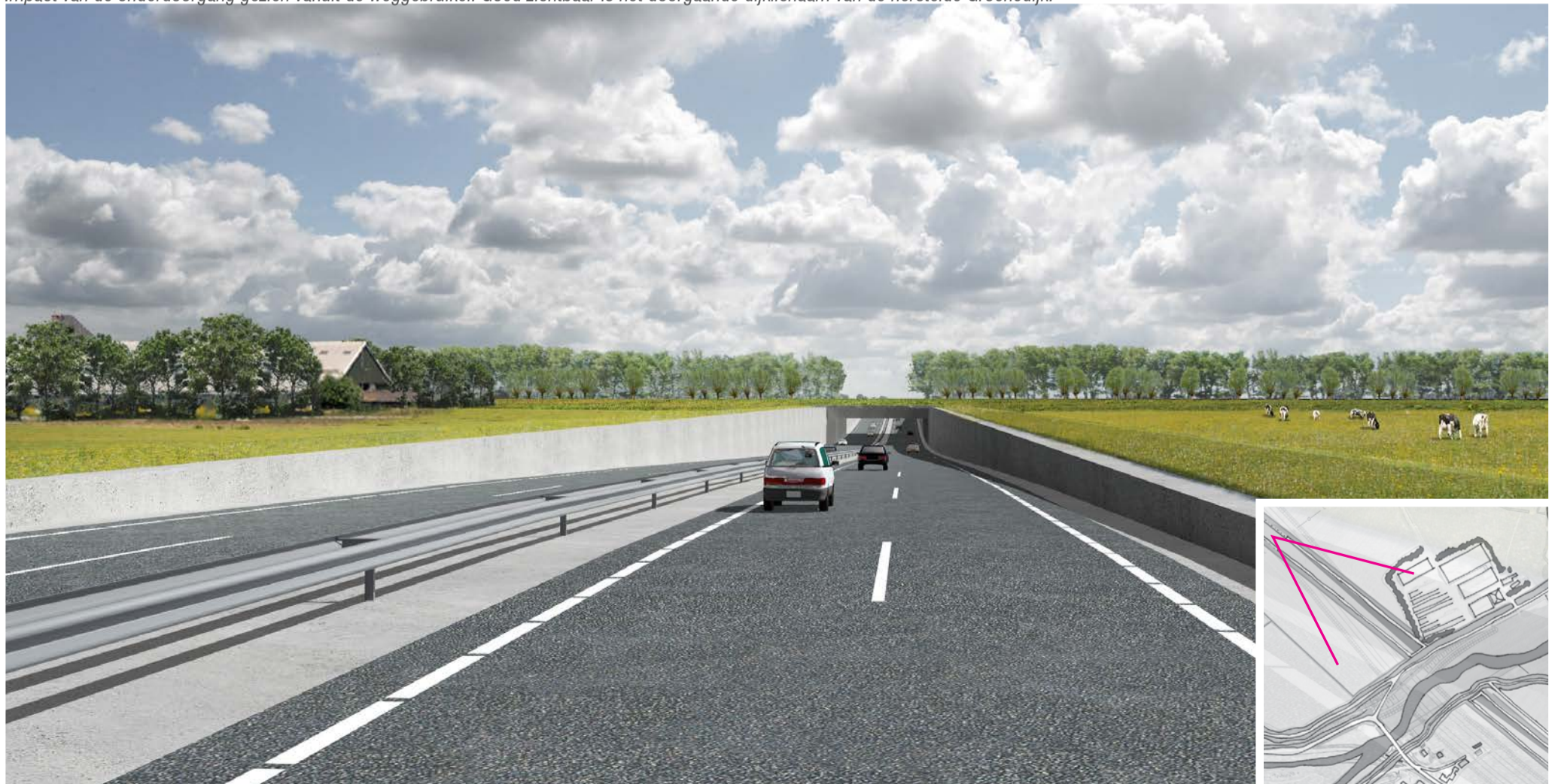
Impact van de onderdoorgang gezien vanuit de weggebruiker. Goed zichtbaar is het doorgaande dijklichaam van de herstelde Groenedijk.
