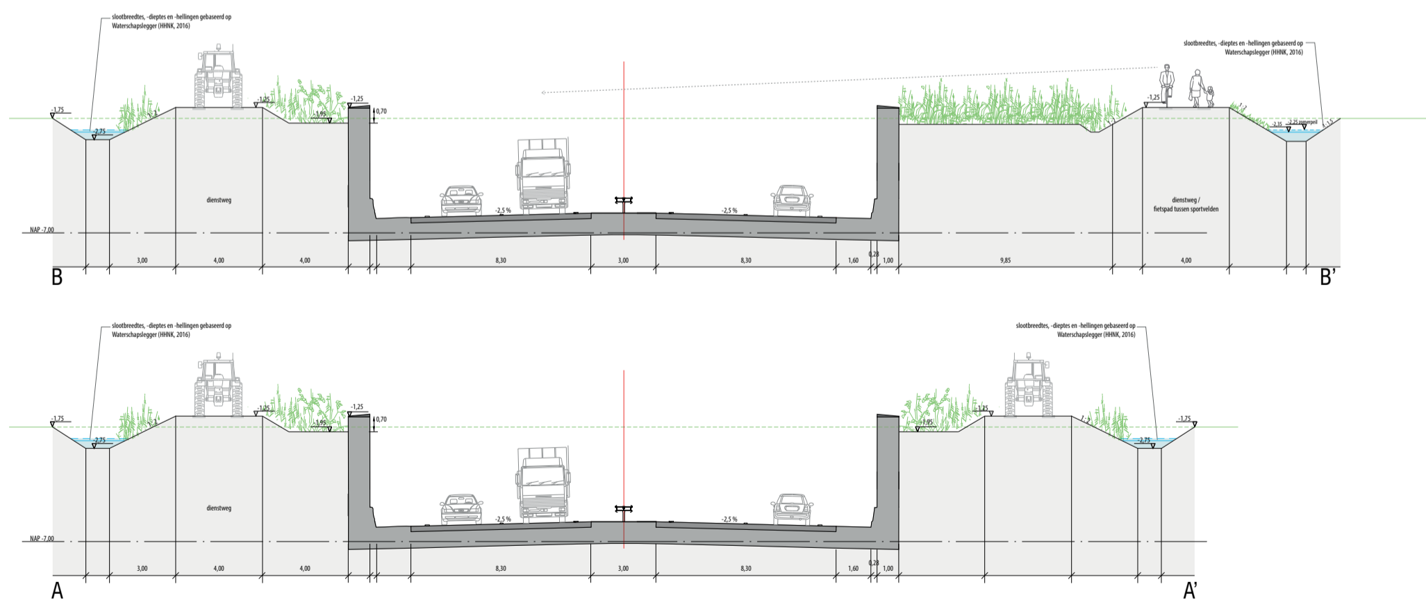
Dwarsdoorsnede Dorpsstraat met onderhoudspaden die tevens ingezet kunnen worden als recreatieve paden
